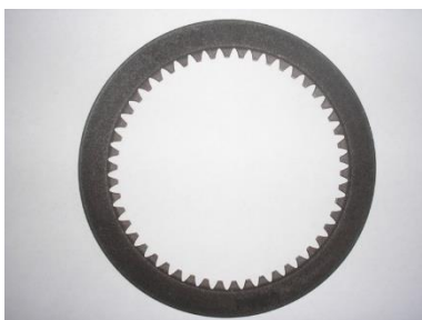
Рисунок 14 – Фрикційний диск з псевдосплавним покриттям Cu-ПД(Fe-FeB)
