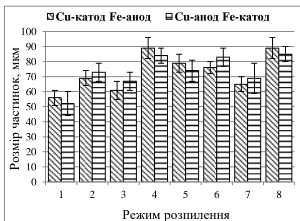
Рисунок 5 – Розмір частинок, що отримані при сумісному розпиленні дротів Cu і Fe на різній полярності
